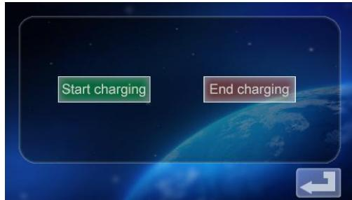
g. Appuyez sur l'icône **[End charging]** pour désactiver la charge. L'écran d'information sur la charge s'affiche, indiquant la durée de la charge et la puissance chargée.
