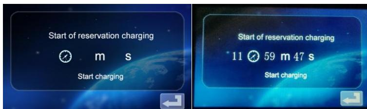
Nach der vereinbarten Zeit wird das Gerät automatisch in den Ladezustand versetzt.
