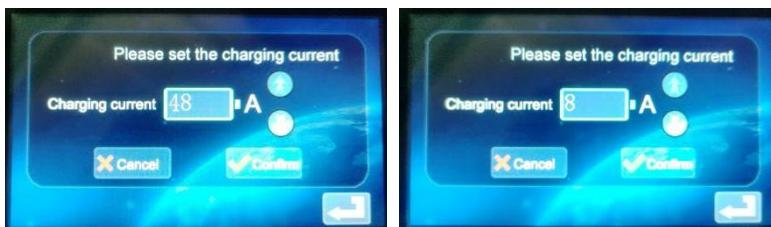
c. Mindeststrom 8A, Maximalstrom 48A, Stufe 8A; nachdem Sie den entsprechenden Strom ausgewählt haben, klicken Sie auf das Symbol . Wenn der Ladestrom erfolgreich eingestellt wurde, geben Sie die Schnittstelle für die erfolgreiche Einstellung ein:
