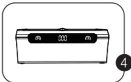
4) Après la connexion, le voyant du bouton d'alimentation (①) et le voyant du bouton de commutation de mode (②) s'allument. La machine est prête à être utilisée lorsque l'affichage LED indique 000.
